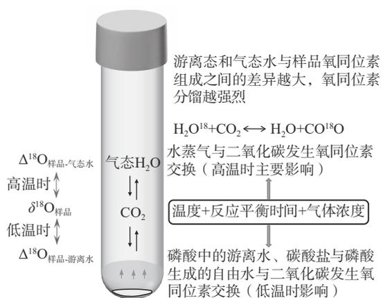
注:  $\Delta^{18}\text{O}$  值表示样品与酸生成的  $\text{CO}_2$  气体的氧同位素组成与酸中游离态或气态水的氧同位素组成之间的差异
