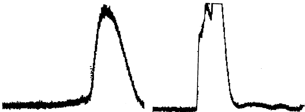
图1 p,p'-DDT在210 nm处出峰 色谱图出峰时间23 min~30 min
