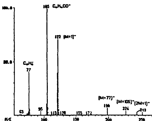
图 1 C_6H_5CONH_2 的质谱图
