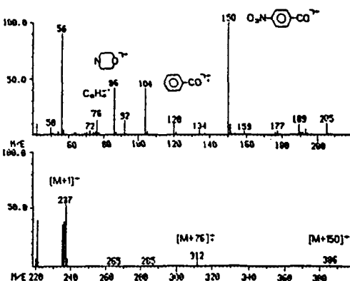
图10 O 2 N-C 6 H 4 -CON(CH 2 CH 2 ) 2 的质谱图
