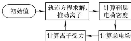
图 2 混合模型程序流程图
