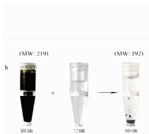
图 2 三嗪与硫化氢的反应原理(a)、反应前后对比图(b)
